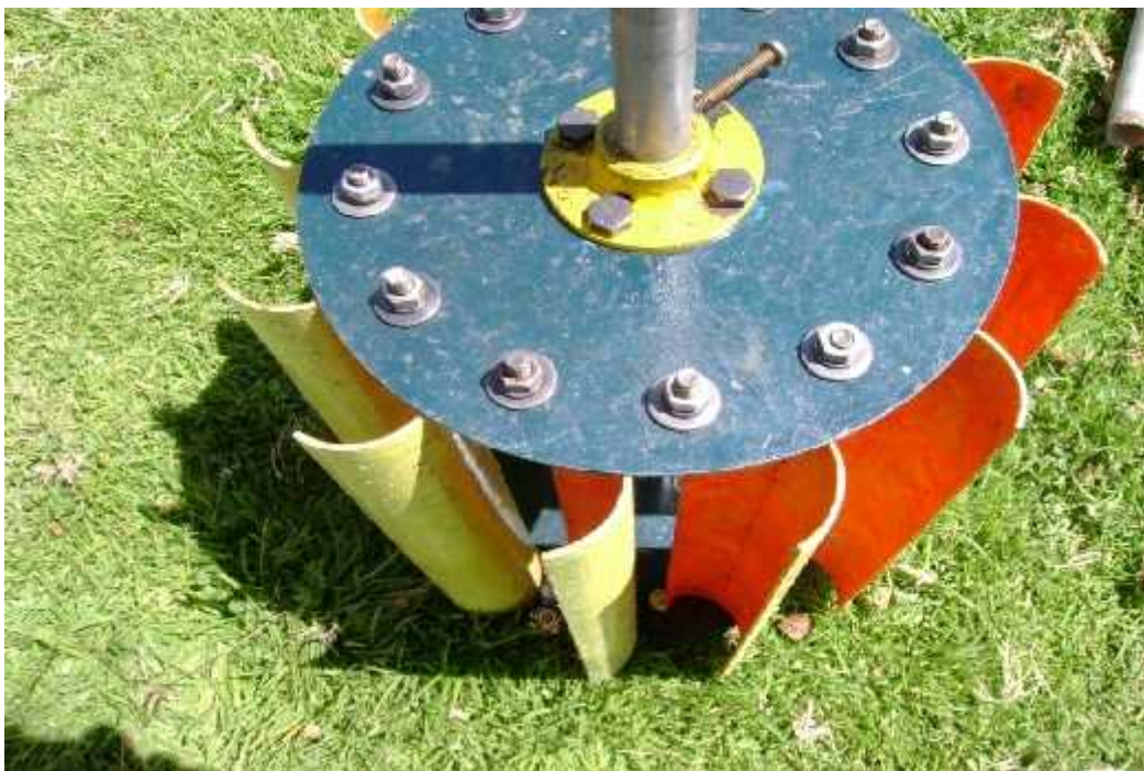
FOTOGRAFÍA N°04. Módulo experimental, acondicionado para el tratamiento con 12 álabes y 90°.
