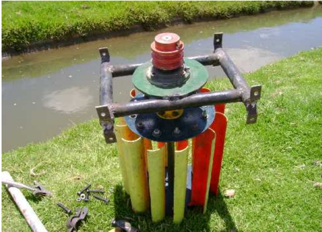
FOTOGRAFÍA N°03. Módulo experimental, acondicionado para el tratamiento con 12 álabes y 75°.
