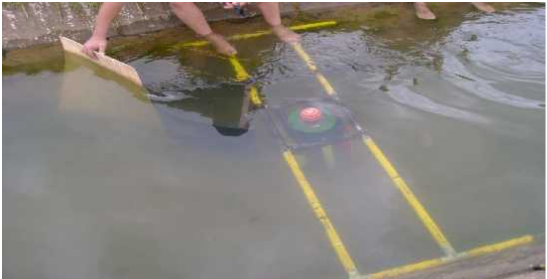
FOTOGRAFIA N°02. Direccionado el flujo del agua hacia la turbina, para obtener mayor RPM.
