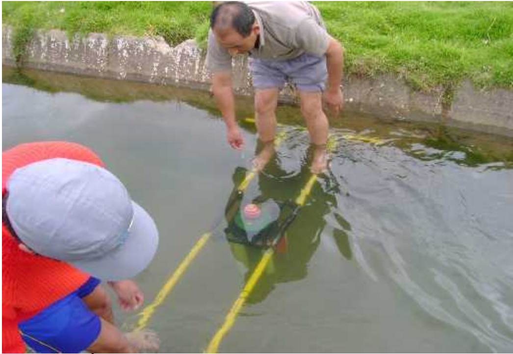
FOTOGRAFÍA N°01. Pico turbina de eje vertical, puesta en plena prueba experimental, en el canal de irrigación de Orcotuna. Con 6 álabes y ángulo de 105^{\circ} .
