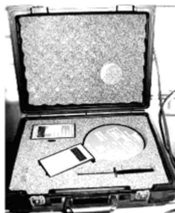
Figura 4.2 Equipo Holaday EMF Measurement HI-3604
