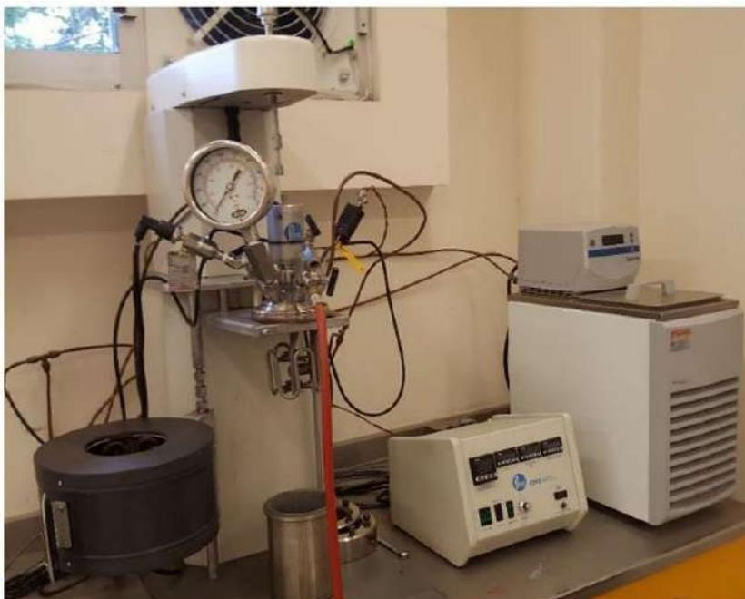
Para la cianuración convencional, las pruebas se realizaron a temperatura ambiente y en condiciones de presión atmosférica: 2 g/L NaCN, 3 kg/ton CaO para control de pH, una proporción de sólidos del 20%, un tiempo de lixiviación de 72 h y un tamaño de partícula de-Malla 100 (149  $\mu\text{m}$ ).
