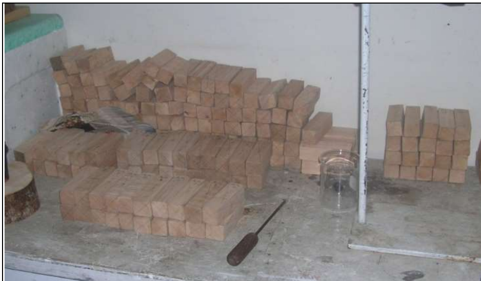
2. Probetas del Eucalyptus tereticornis Sm lista para los Estudios anatómicos y físicos.
