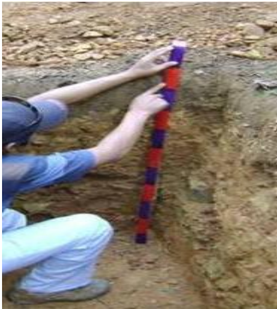
Fotografía 01. Medición de características físicas del suelo en calicata.
