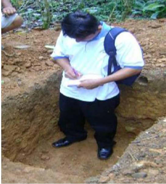
Fotografía 05. Medición de características físicas del suelo en calicatas abiertas
