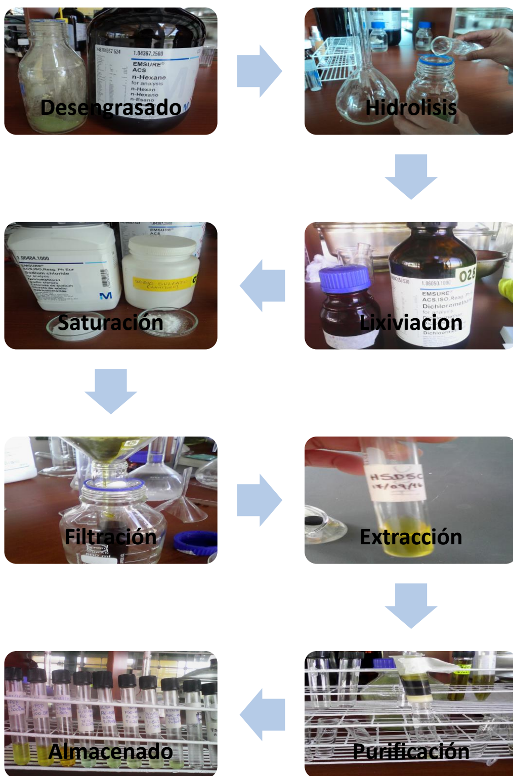
Figura 22. Proceso de extracción por diclorometano de bencil isotiocianato a partir de hojas de mastuerzo
