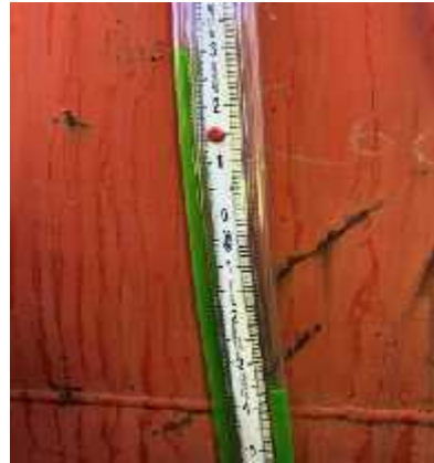
Figura 30. Presión estática, ventilador COD 100 de CMCSA.
