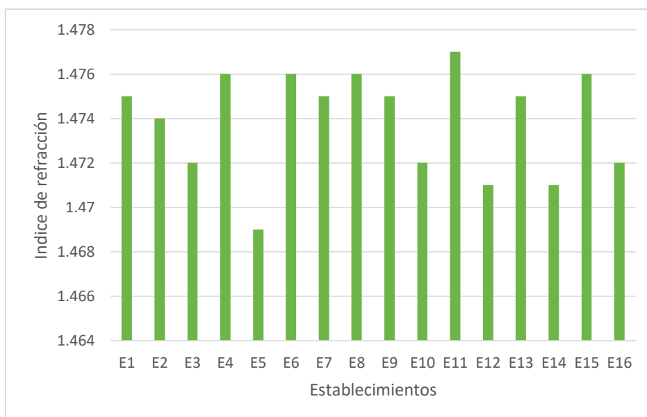
Figura 9. Variación de índice de refracción en muestras de aceites de fritura
