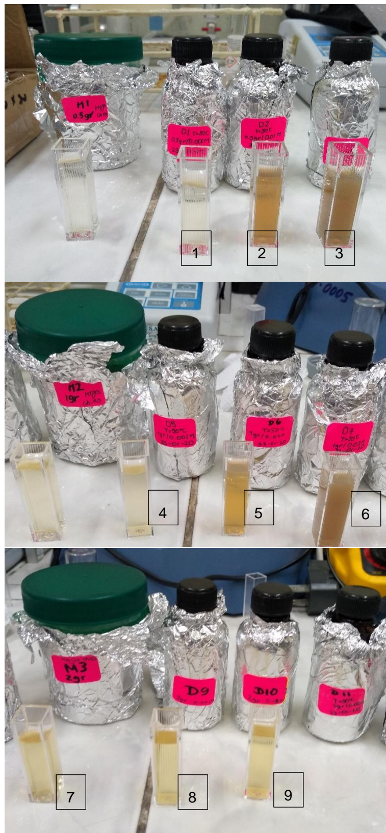
Figura 40 NP's Ag sintetizadas con extracto de hojas de Chuquiraga spinosa
