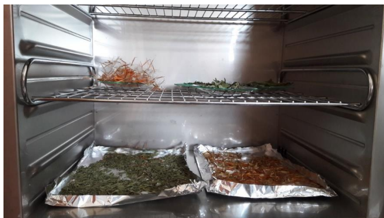
Figura 15 Hojas y flores de Huamanpinta secando en la estufa a 40°C por 1 hora
