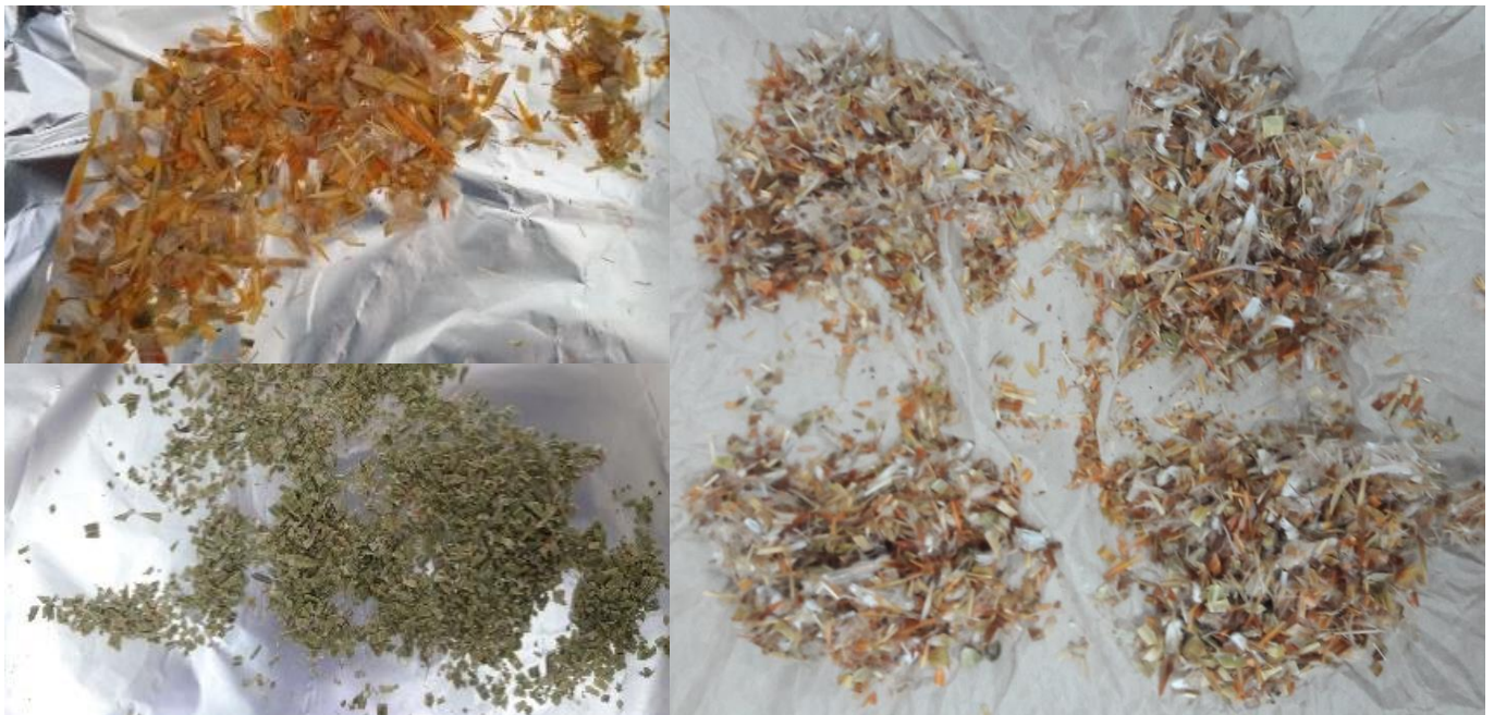
Figura 333 Disminución de tamaño de las muestras (izquierda) y cuarteo de la muestra (derecha) para proceder al pesado
