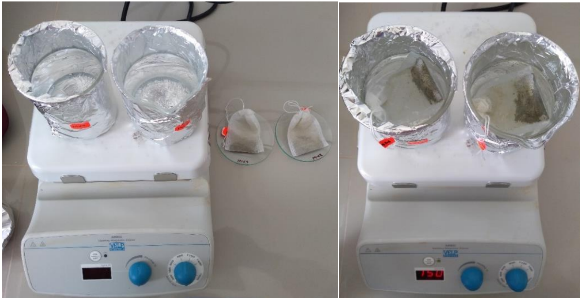
Figura 35 Inmersión del filtro con la muestra en 200ml de agua ultrapura a 60°C
