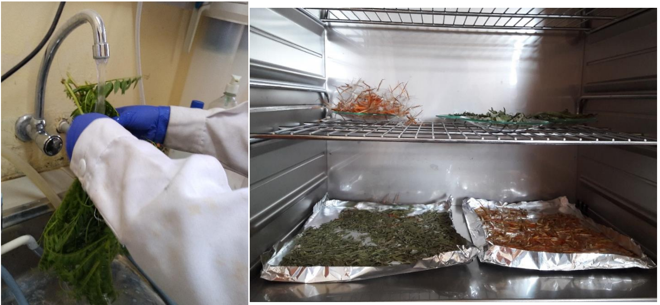
Figura 333 Disminución de tamaño de las muestras (izquierda) y cuarteo de la muestra (derecha) para proceder al pesado
