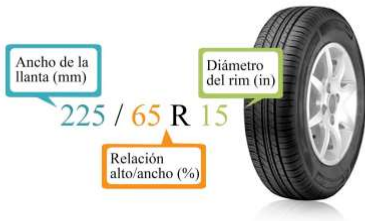
Figura 2. 3 Nomenclatura del neumático
