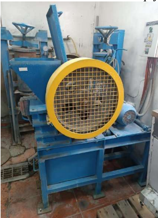
Ilustración 6: Chancadora de quijada y molino de bolas
