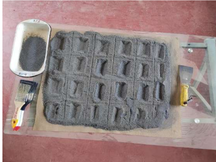
Foto 04: Muestra tomada por incrementos
