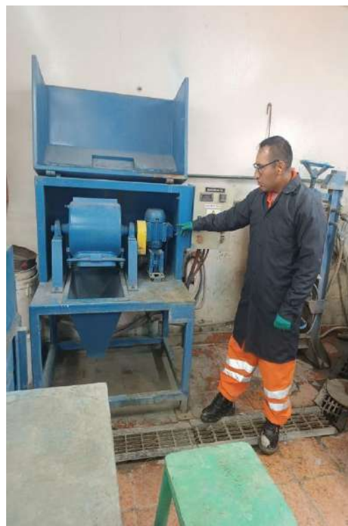
Ilustración 6: Chancadora de quijada y molino de bolas
