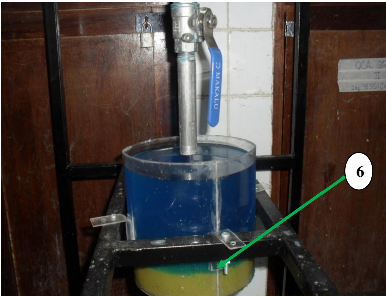
Figura N° 16: Precipitación del fierro
