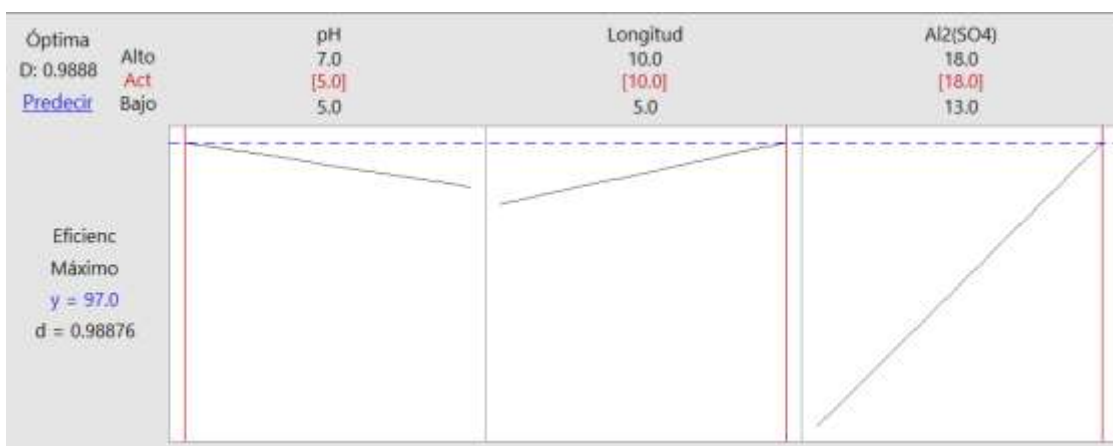
Figura 31: Gráfica de optimización de la eficiencia de remoción de la turbidez
