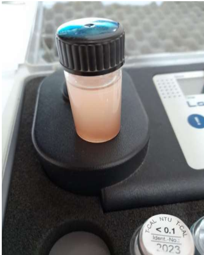
Medición de muestras en el turbidímetro para la primera experimentación
