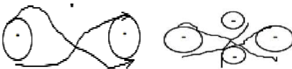
Figura 1: Enlace de los coágulos por acción de las fibras textiles
