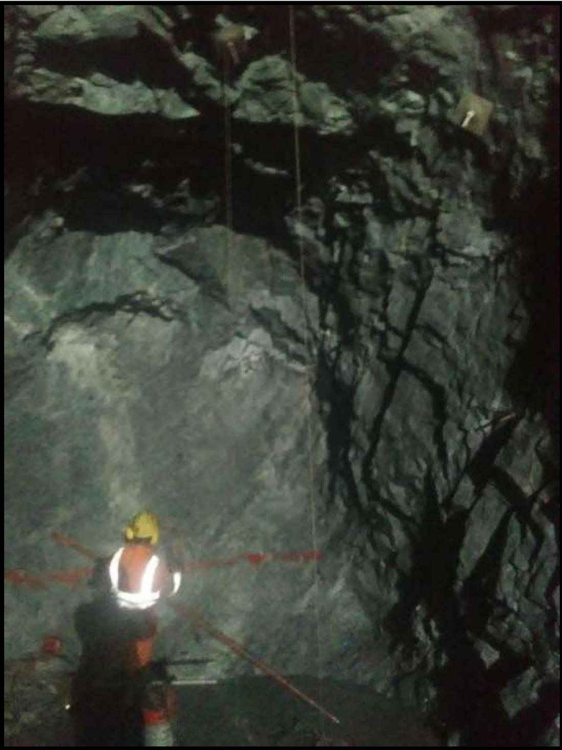
PINTADO DE GRADIENTE Y PUNTO DE DIRECCION
