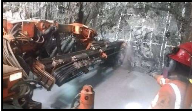
FIGURA 2. PERFORACIÓN DE FRENTE
