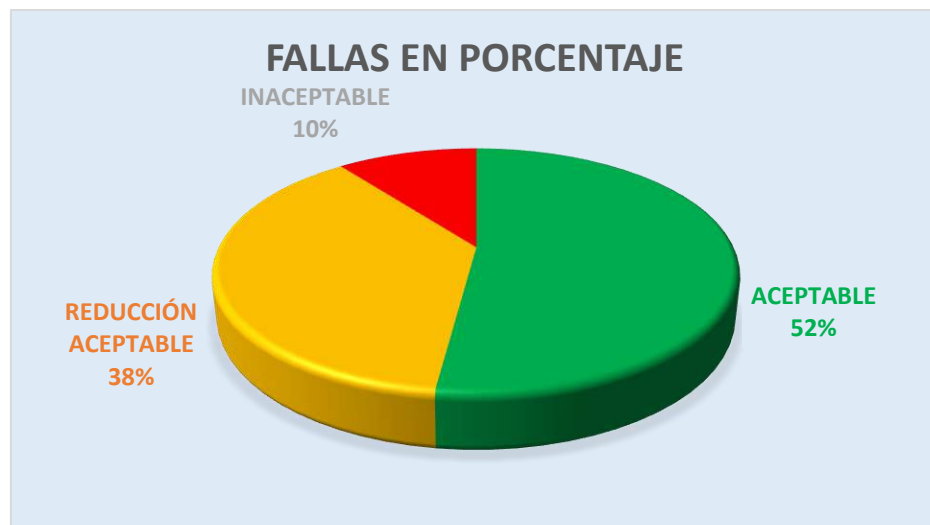
Figura 5.6: Características en porcentaje de las fallas del sistema Moto compresor.
