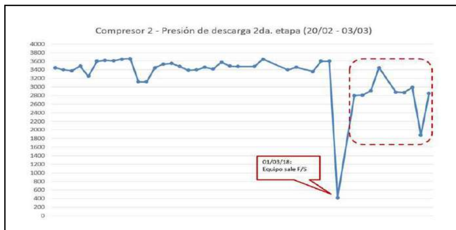
Figura 1.1 Se aprecia una consistente caída de presión desde el 01/03/18 (líneas enmarcadas en rojo).
