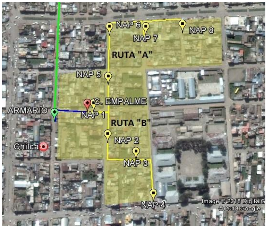
Figura 29. Despliegue de la red de conexión y cajas NAP del sector 1 Fuente: Imagen Google Earth Elaboración: Propia
